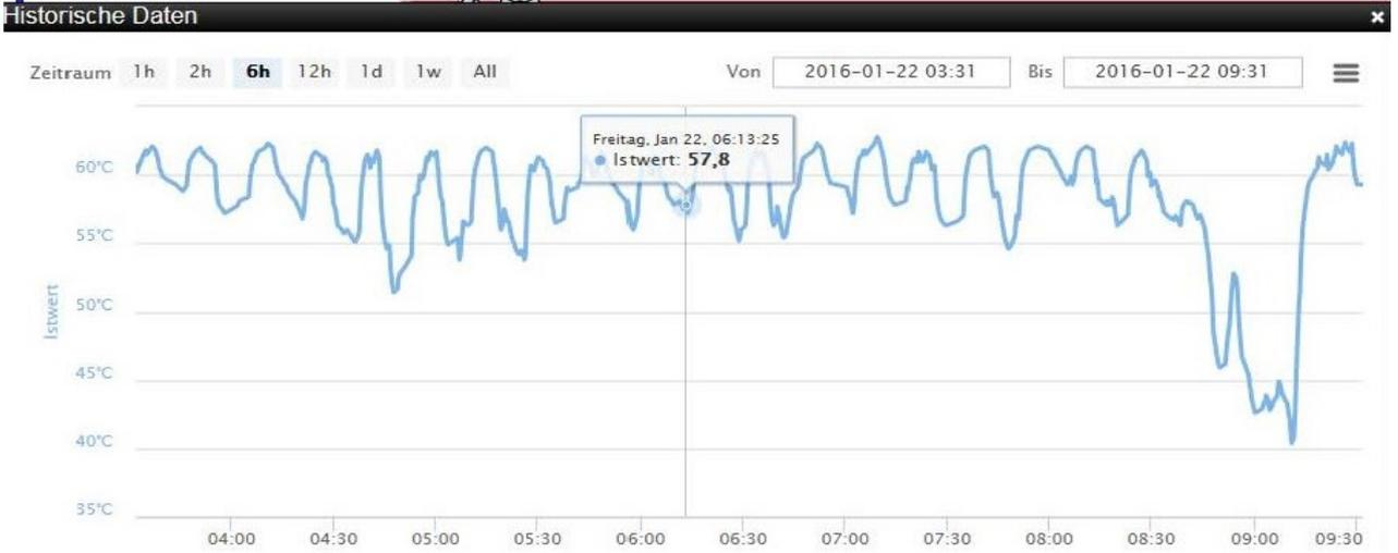
PQM: Warmwassersystem für Küche anhand Leitbild überprüft, Temperaturverlauf im Tagesverlauf
